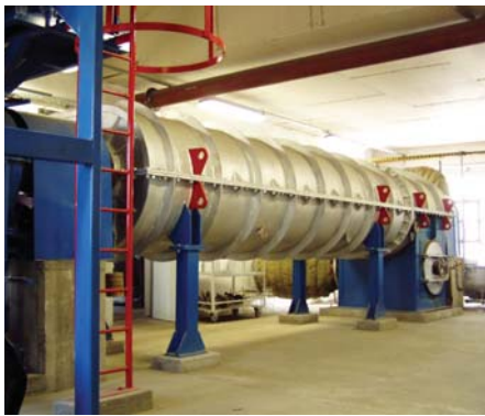
Foto: 3R Unidad de producción de biochar de emisión cero, de Edward Someus
